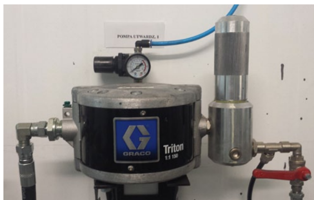
Pompa Triton dostarcza gotową mieszankę farb.
