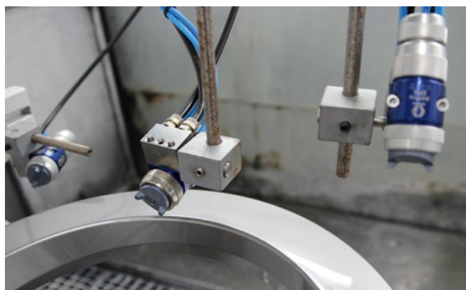
Automaty lakiernicze malują detale niezwykle szybko, zapewniając powtarzalność i doskonałą jakość powłok.
